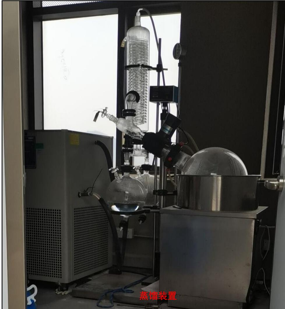
图 4.1.1-3 废水蒸馏处理设施现场照片
